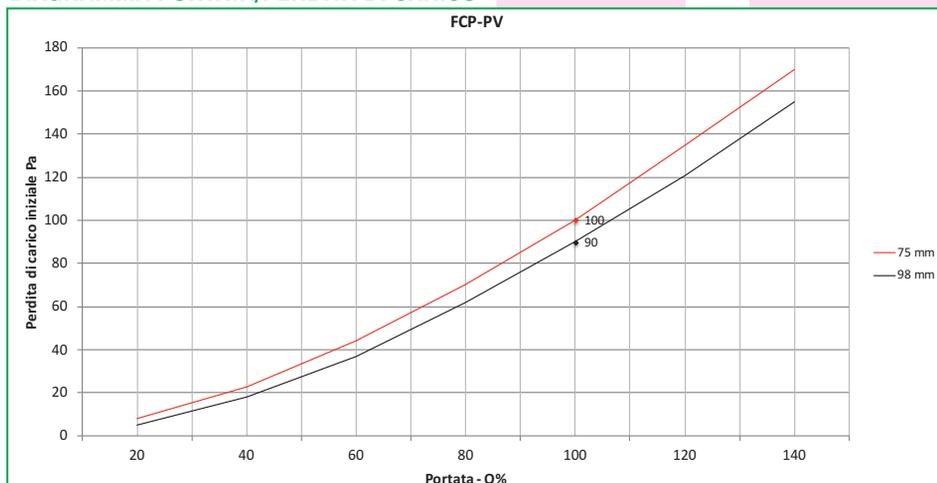
Nota : Il diagramma è fornito per la portata Q100% pari a 3.400 m<sup>3</sup>/h
